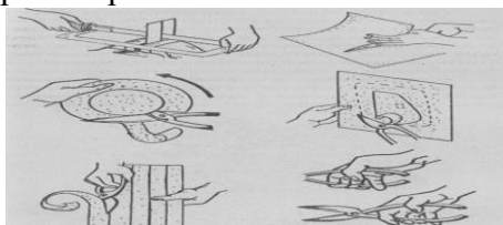
Рис. 1. Приемы работы с ножовкой по металлу и слесарными ножницами
