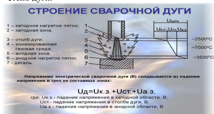
Рис. 2. Строение электрической дуги и распределение напряжения на ее участках: 1 - катодное пятно; 2 - столб дуги; 3 - анодное пятно
