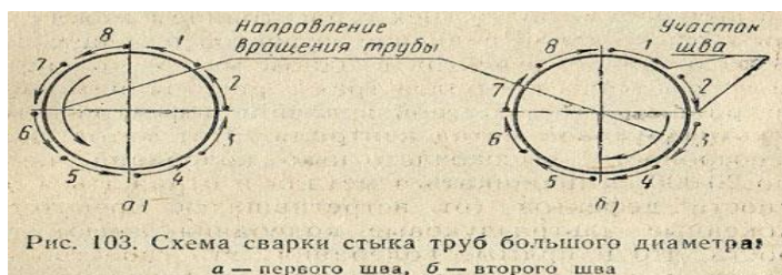
Рис. 6. Схема сварки стыка труб большого диаметра: а - первого слоя; б - второго слоя
